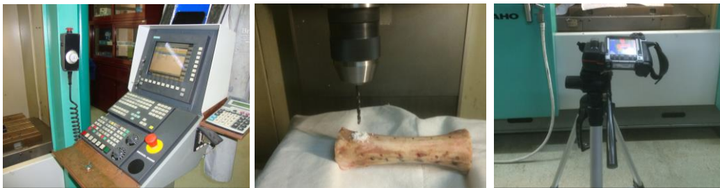
Figura 14. Equipamento utilizado na furação do osso bovino e blocos
