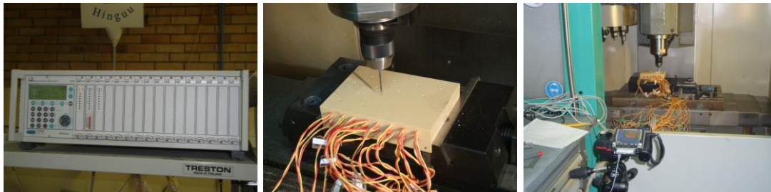
Figura 4. Equipamento utilizado na furação do material compósito
