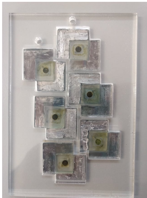
Figura 4.3: Instalação das Células na base de acrílico.
