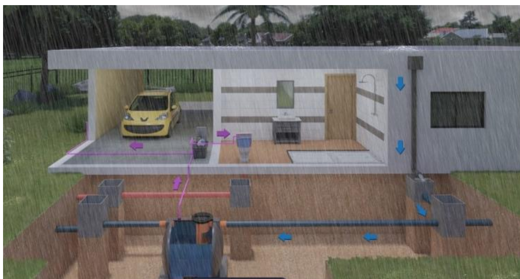
Figura 6: Sistema de Aproveitamento de Águas Pluviais (SAAP).
