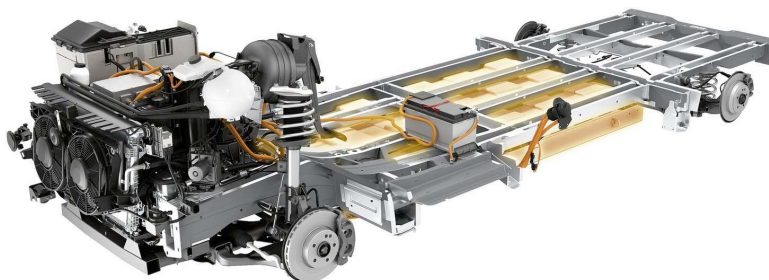
Figura 2.1: Exemplo de um chassis de uma Mercedes Vito [20].
