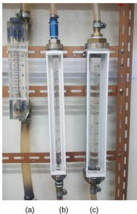
Figura 3.3: (a) Rotâmetro de água R3, (b) Rotâmetro de água R2, (c) Rotâmetro de água R3.
