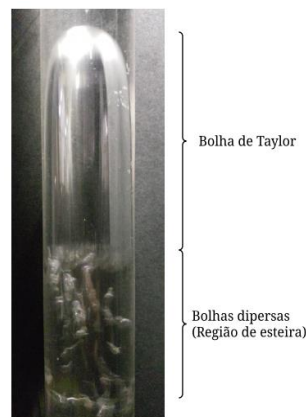
Figura 2. 2: Escoamento vertical ascendente no regime slug flow .
