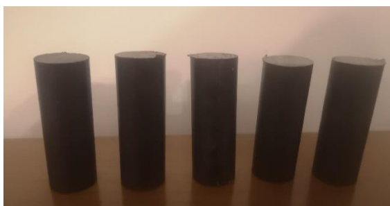
Figura 13 – Blocos cortados nas dimensões referidas de 60 milímetros
