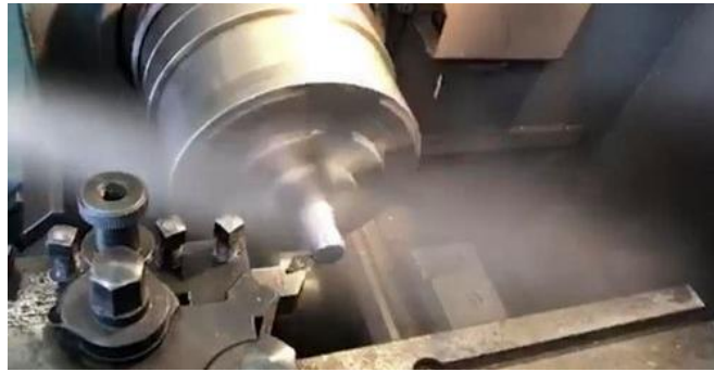
Figura 16 – Torneamento com lubrificação por MQL
