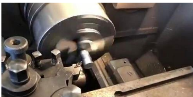
Figura 15 – Torneamento sem lubrificação
