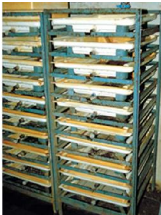
Figura 1.10. Incubadora de Tabuleiros Verticais (adaptado de Hoitsy et al. 2012)
