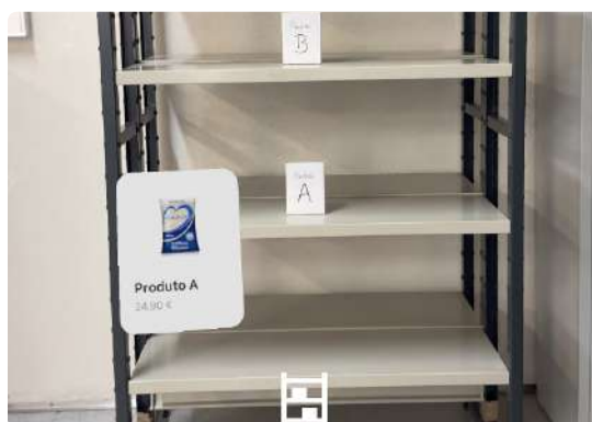
Figura 6.10: Desalinhamento causado por microvariações na angulação do dispositivo durante a inicialização.
