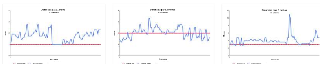
Figura 6.9: Variabilidade da estimativa de distância baseada em RSSI em comparação com as distâncias reais de 1m, 2m e 3m.
