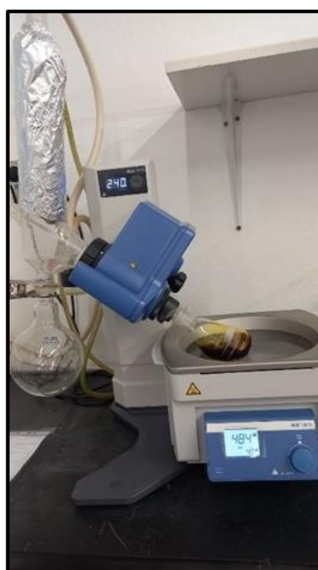
Figura 5 – Extrato da própolis no evaporador rotativo.
