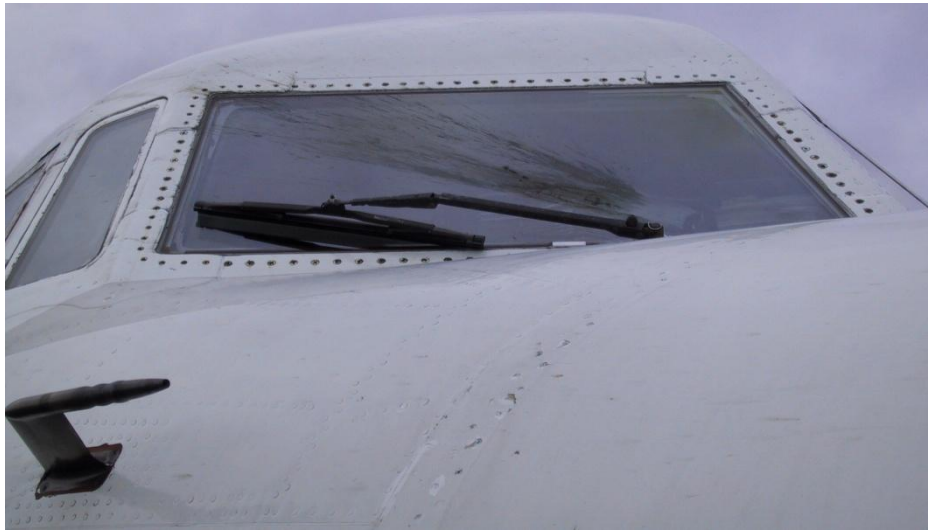
Fig.3.2- Pára-brisas de uma aeronave após resistir ao impacto de uma ave. [1]
