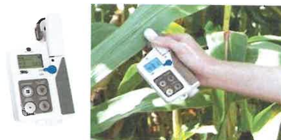
Figura 7.1 – Medidor de clorofila SPAD-502 Plus que estima o teor de clorofila nas folhas medindo a transmitância da luz através da folha em dois comprimentos de onda, 650 nm (luz vermelha absorvida pela clorofila) e 940 nm (luz infravermelha não absorvida pela clorofila)
