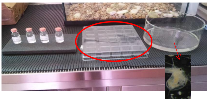
Figura 6 – Kit comercial que pode ser utilizado para a realização de testes ecotoxicológicos com Daphnia spp. De salientar o “tabuleiro” onde se podem fazer os testes utilizando diferentes concentrações do poluente a testar (assinalado a vermelho)
