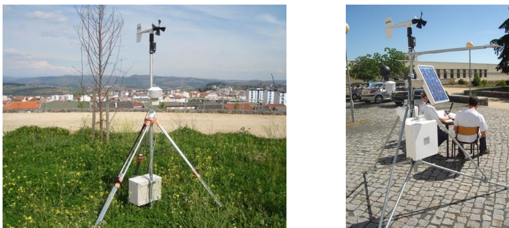
Figura 13 - Estações Meteorológicas Automáticas da rede de monitorização do clima da cidade de Bragança
