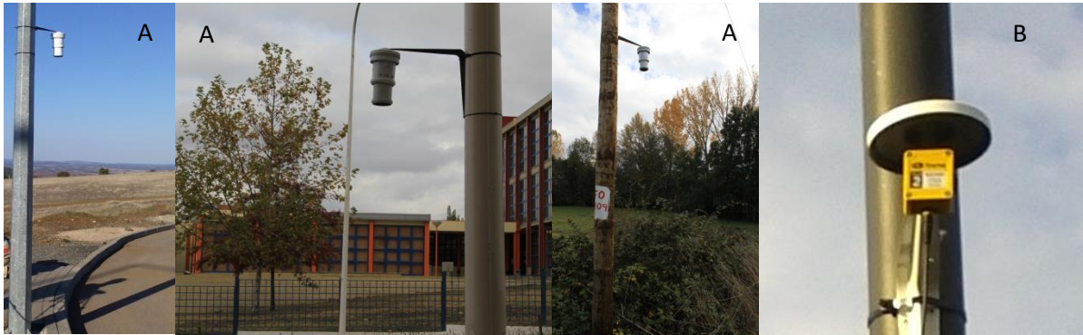
Figura 14 - Locais com monitorização da temperatura e humidade relativa (A); pormenor do sistema de medição sem o abrigo (B)
