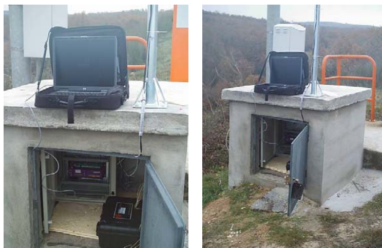
Figura 6.15 – Operação de transferência de dados a partir do datalogger
