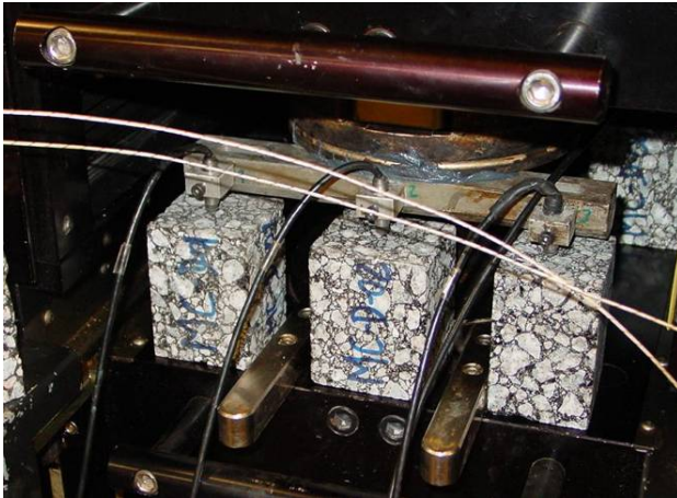
Figura 5.5 – Colocação das amostras para o ensaio de retracção térmica livre
