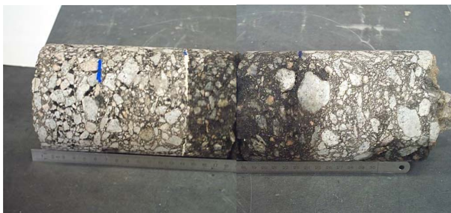
Figura 6.8 – Identificação das camadas de pavimento através duma amostra de pavimento
