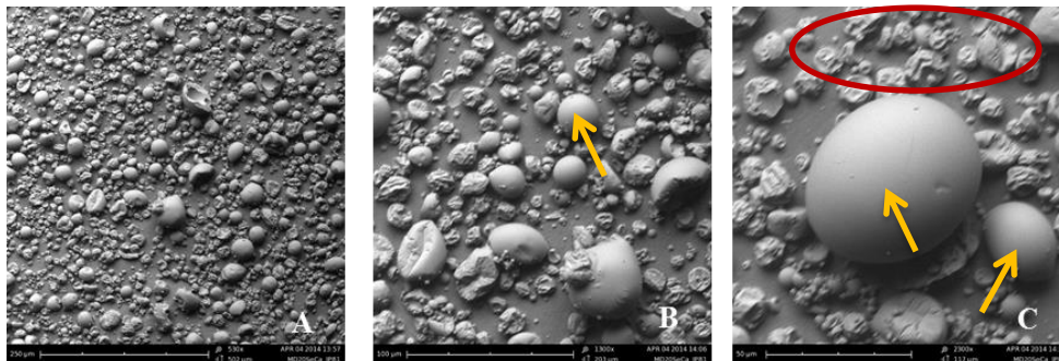
Figura 3.4 – MEV das Mic de SI:Ca (1:1). A) Ampliação 530x. B) Ampliação 1300x. C) Ampliação 2300x. As setas a laranja indicam Mic com superfície lisa e a área a vermelho Mic com superfície rugosa.
