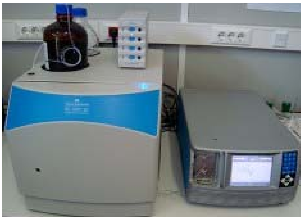
Figura 4. Vista real do Polymer Laboratories PL-GPC-50 contendo o sistema SEC com refractómetro diferencial na gama de 950 \pm 30 nm ligado a um detector de dispersão de luz multi-ângulo Wyatt Technology DAWN8 + HELEOS 658 nm
