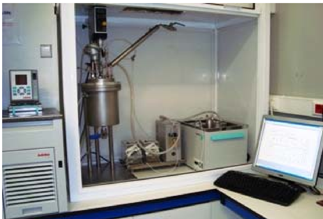
Figura 2. Imagem real do equipamento usado na polimerização linear ou não linear, convencional ou controlada, do sistema MMA/EGDMA.
