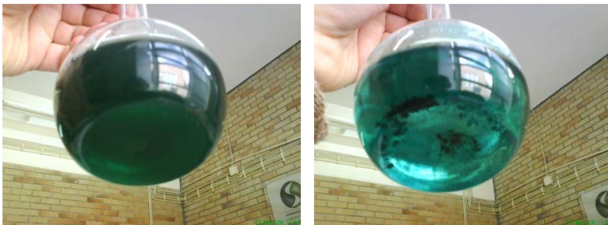
Figura 3. Comparação de duas soluções de MMA/EGDMA com CuBr e HMTETA. Na imagem da direita está patente a fraca dissolução do metal. Na da esquerda, com a adição do co-solvente DMF, constata-se que o metal se dissolveu quase na totalidade.
