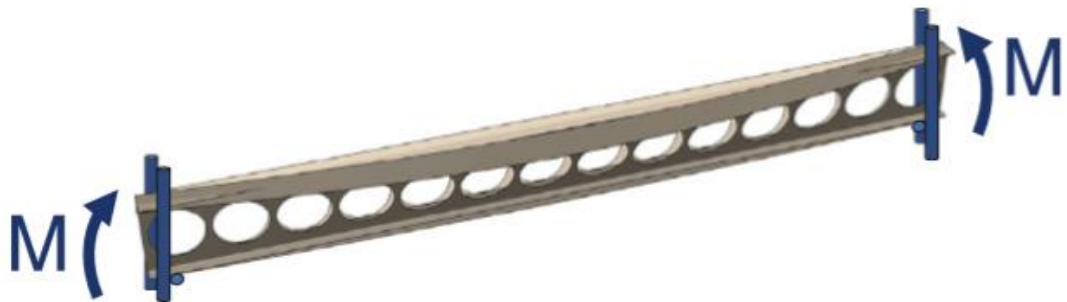
Figura 17 – Encurvadura lateral torsional, [26].
