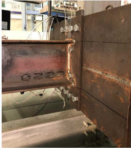
Figura 50 – Simulação do encastramento nos testes experimentais.
