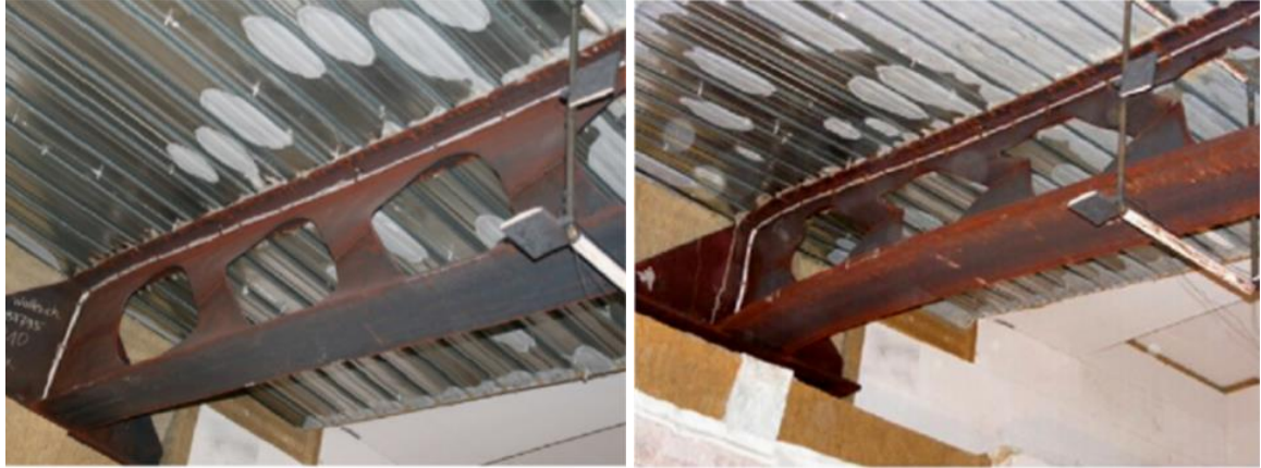
Figura 11 – Encurvadura do montante da alma por corte, [15].
