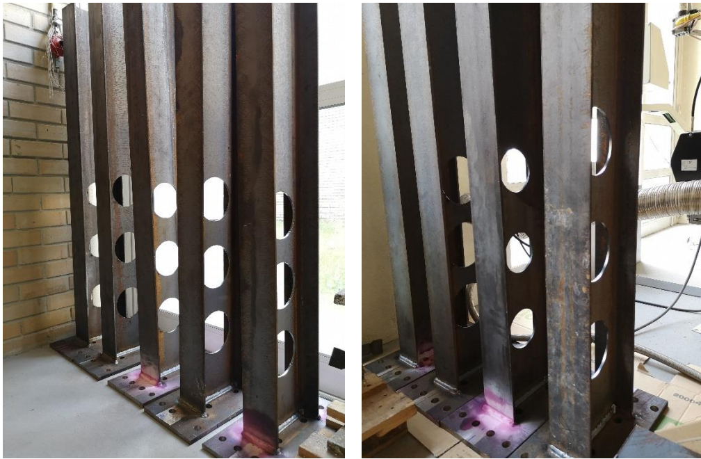
Figura 61 – Vigas alveolares perfuradas para ensaio.
