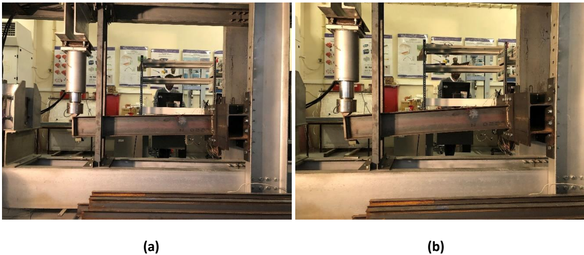
Figura 67 – Deformação final da viga B1-2. (a) Instante pré-ruptura de solda. (b) Instante pós-ruptura de solda.
