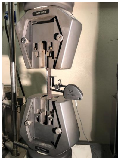
Figura 56 – Máquina utilizada para o ensaio à tração juntamente com o extensômetro mecânico.
