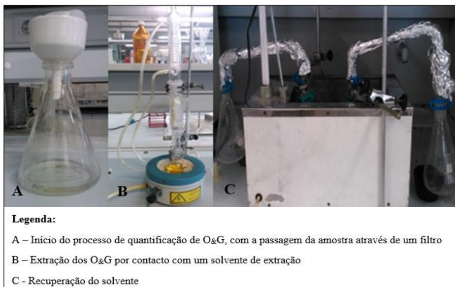
Figura 3.3 – Instalação experimental para a determinação de O&G
