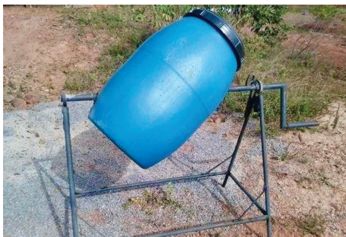
FIGURA 6.10 – Misturadora artesanal para preparação de alimentos concentrados.
