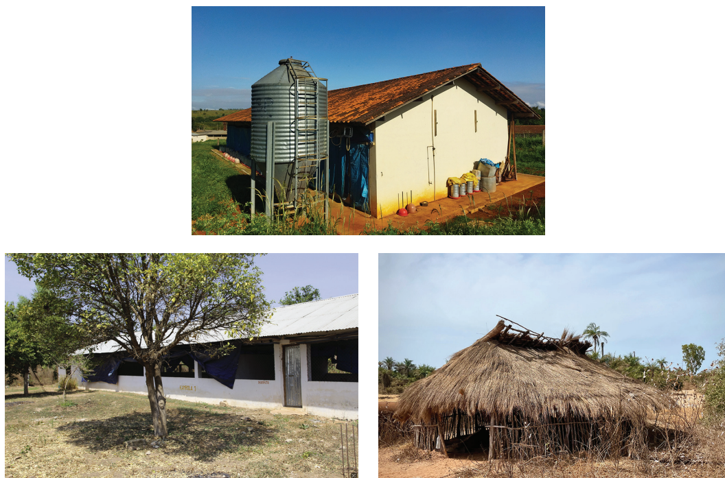
FIGURA 4.18 - Diferentes materiais que podem ser usados na construção do telhado: telhas de barro (a), chapas de alumínio (b) ou palha/capim em avicultura familiar (c).
