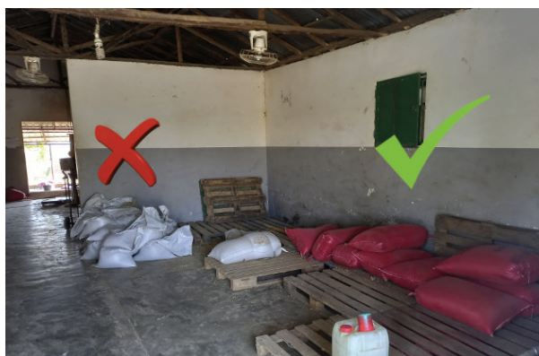
FIGURA 6.1 – Matérias-primas armazenadas numa pequena fábrica de alimentos concentrados. As sacas estar sempre sobre um estrado (ex. palete), evitando o contacto directo com o chão. A presença de grande quantidade de grãos no chão potencia os desperdícios e favorece a presença de pragas.
