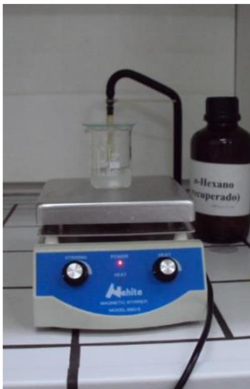
Figura 4.2. Procedimento de preparação do metóxido de sódio.
