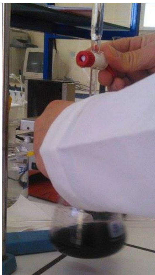
Figura 4.13. Titulação de padronização do \text{Na}_2\text{S}_2\text{O}_3 \cdot 5\text{H}_2\text{O} após adição de amido.
