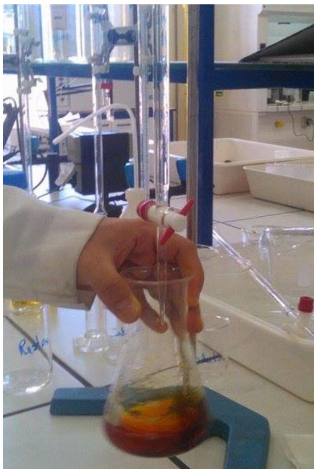
Figura 4.12. Ponto de viragem da titulação de padronização do \text{Na}_2\text{S}_2\text{O}_3 \cdot 5\text{H}_2\text{O} .
