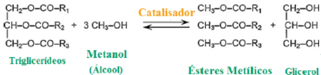
Figura 2.3. Reação de transesterificação com metanol e catalisador básico [26].
