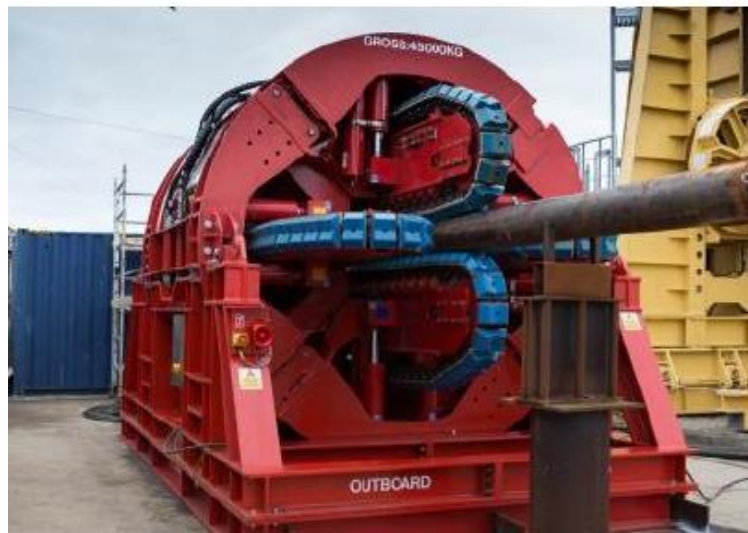
Figura 17 – Tensionadores de um sistema HLS [13]
