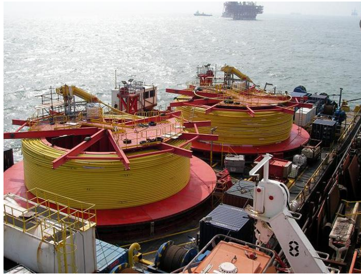
Figura 15 – Armazenamento de tubagens flexíveis nos navios instaladores [11]
