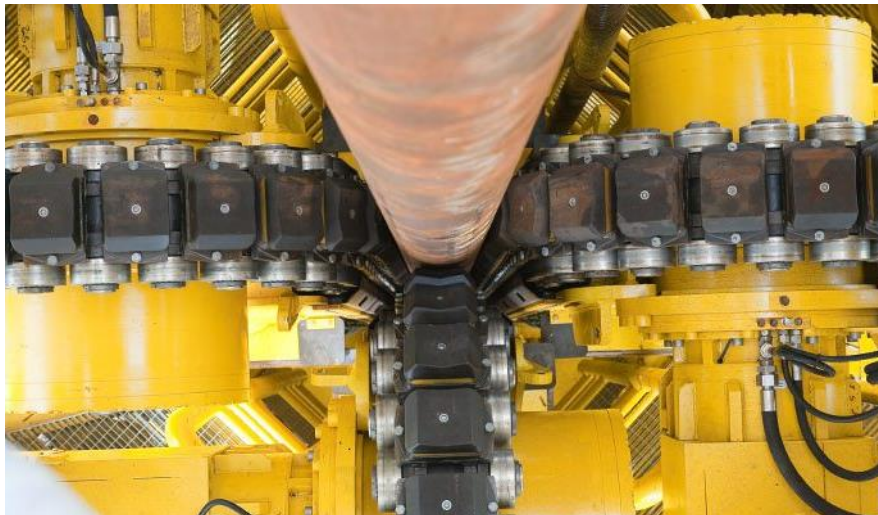
Figura 16 – Tensionadores responsáveis por transmitir a carga para o lançamento dos dutos no leito marinho [12]
