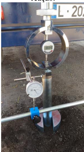
(c) Aparelho de medição da força axial e penetração do pistão.
