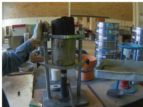
(f) Extração do corpo de prova de solo compactado.
