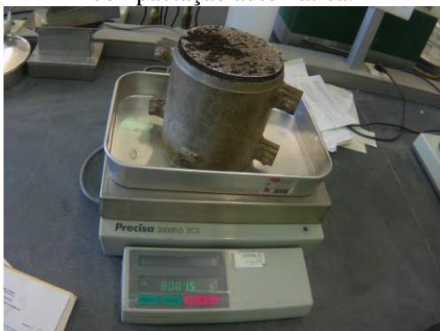
(e) Pesagem do cilindro de compactação + solo úmido.
