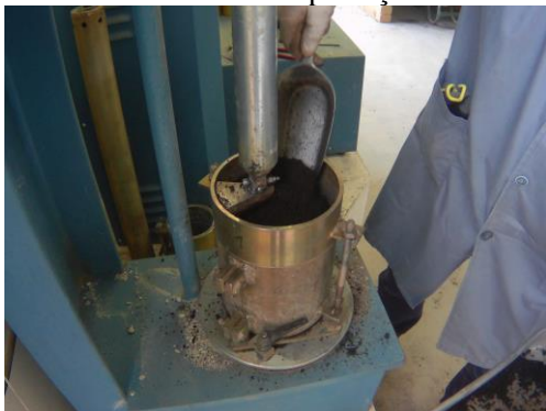
(c) Adição de solos em camadas para compactação automática.
