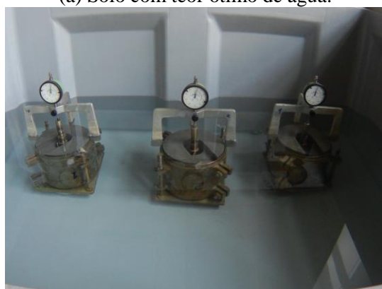
(c) Imersão dos corpos de prova de solo compactado em água.
