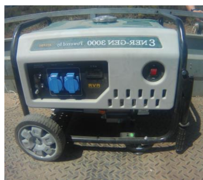
(b) Gerador para fornecer energia ao equipamento.
