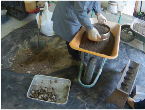
(a) Processo de preparação da amostra para ensaio de compactação.
