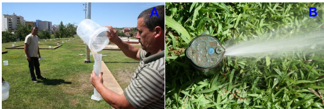
Figura 15 (A) Medição da pluviometria aplicada para avaliação da uniformidade distribuição da rega na parcela/hidrozona CV/NO. (B) Aspensor associado a esta hidrozona (modelo 5000 plus, “Rain Bird”).
