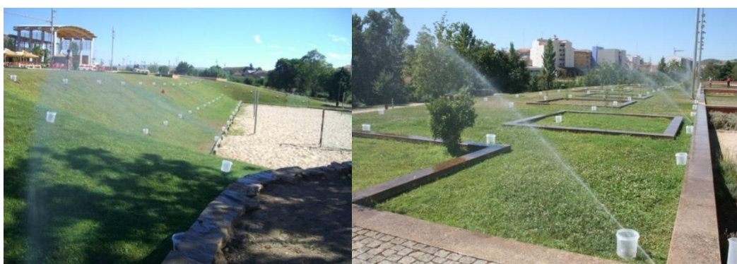
Figura 16 Malha de pluviómetros para avaliação da uniformidade distribuição da rega na parcela/hidrozona CV/NO.
