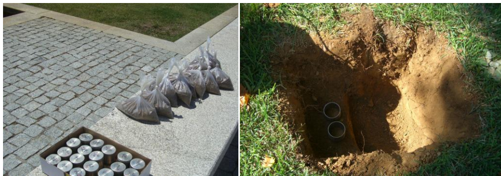
Figura 18 Colheita de amostras de solo perturbadas e não perturbadas, recolhidas à profundidade de 0,0-0,15 m e 0,15-0,30 m, em cada uma das hidrozonas.
