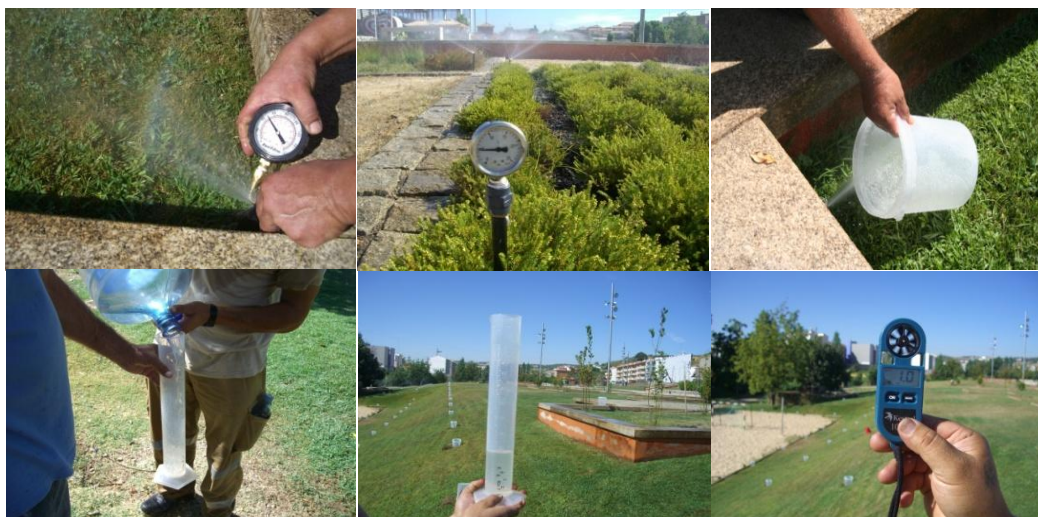
Figura 17 Procedimentos efectuados em cada parcela/hidrozona, relacionados com a medição da pressão, medição directa do caudal e velocidade do vento, antes e no final da realização dos ensaios de avaliação de desempenho.
