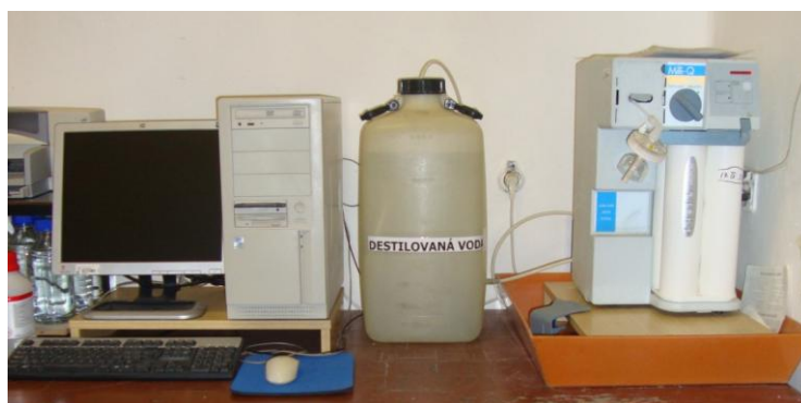
Figura 8 - Computador para aquisição de dados (lado esquerdo) e sistema de água ultra pura Milli-Q RG (lado direito).
