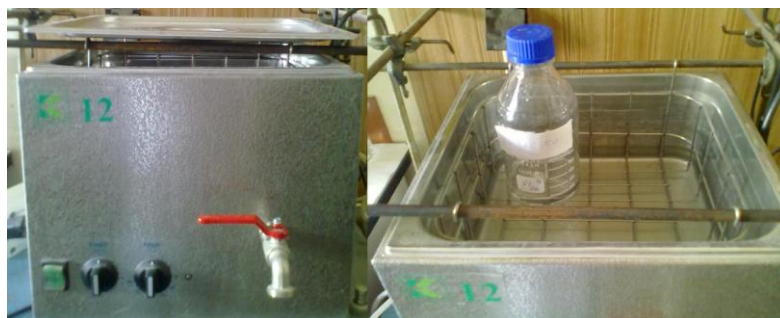
Figura 10 - Banho de ultra sons de frente (lado esquerdo) e com a amostra, visto de cima (lado direito).
