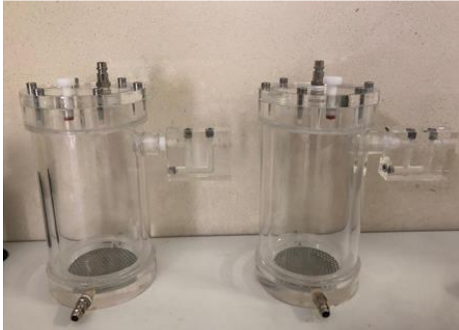
Figura 5. Reator em acrílico usado nos ensaios de digestão anaeróbia.
