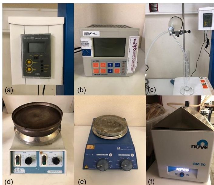
Figura 7. Componentes do sistema de digestão anaeróbia: (a), (b) Medidor de pH; (c) Frasco PE e proveta graduada; (d) e (e) Placas de agitação (f) Banho termostático.
