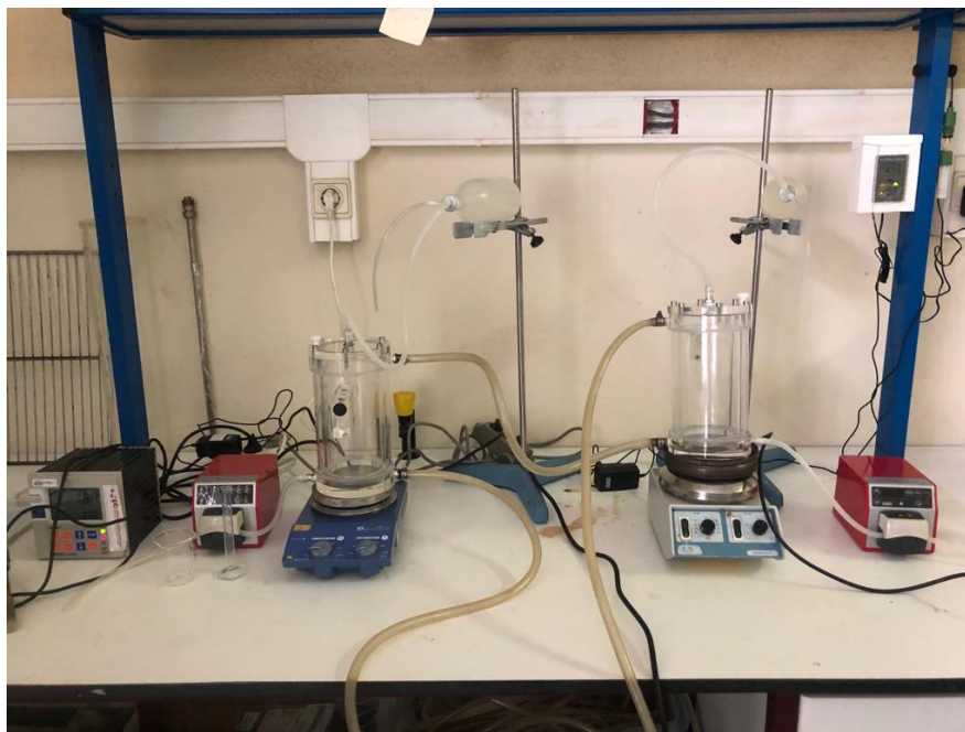
Figura 8. Instalação experimental utilizada nos ensaios de digestão anaeróbia.
