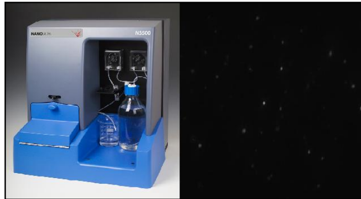
Figura 15: Equipamento Nanosight NS500 (esquerda), imagem retirada do software NTA Software Suite referente à visualização da população de nanopartículas da amostrar em análise (direita) (Adaptado de http://www.nanosight.com/products/ns500 ).
