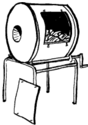
Figura 10: Copo de compostagem do tipo tambor (Rynk & Colt, 1997).
