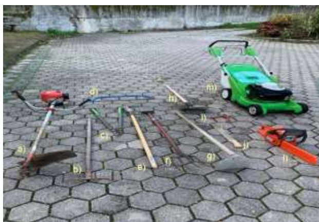
Figura 14: Equipamentos e máquinas disponíveis. a) Moto-roçadora b) Engaçó c) Tesoura de poda (Grande) d) Serrote e) Foíce f) Forquilha g) Sachola h) Pá i) Tesoura de poda j) Catana l) Motosserra m) Corta-Relva.
