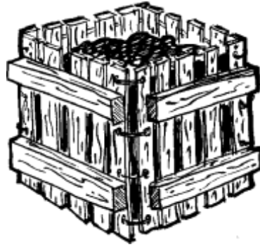
Figura 8: Caixa de compostagem com palete de madeira (Rynk & Colt, 1997).
