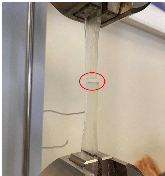
Figura 36 – Fratura de corpo de prova sob ensaio de tração.
