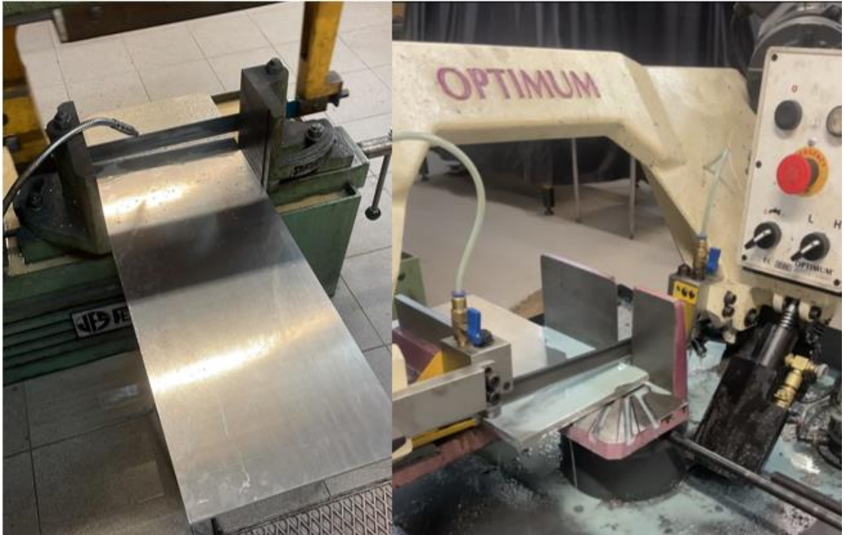
Figura 30 – Corte de chapa de alumínio.
