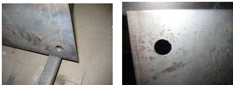
Figura 24 – Furo do gás nas partes laterais do filtro
