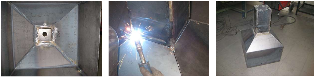
Figura 18 – Ligação do reservatório à caldeira
