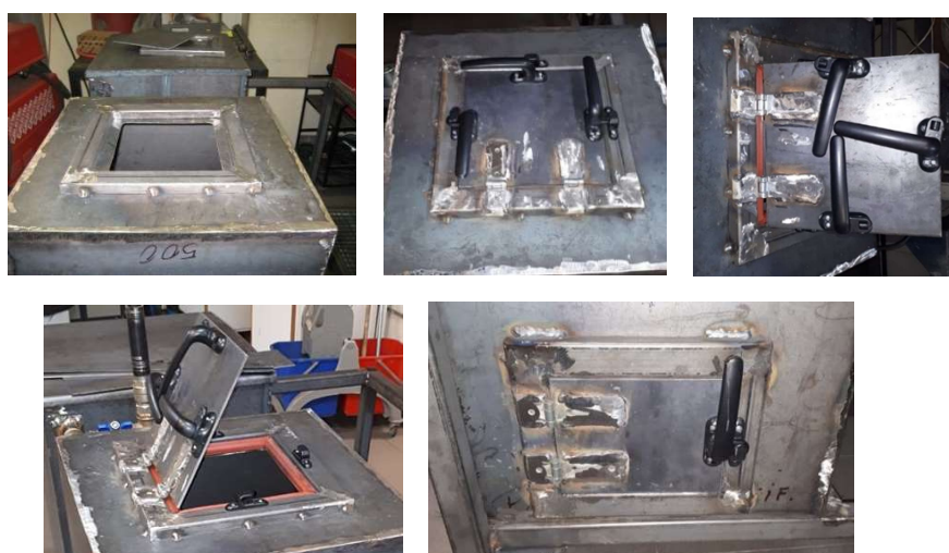
Figura 37 – Tampas do gaseificador e vedante de alta temperatura
