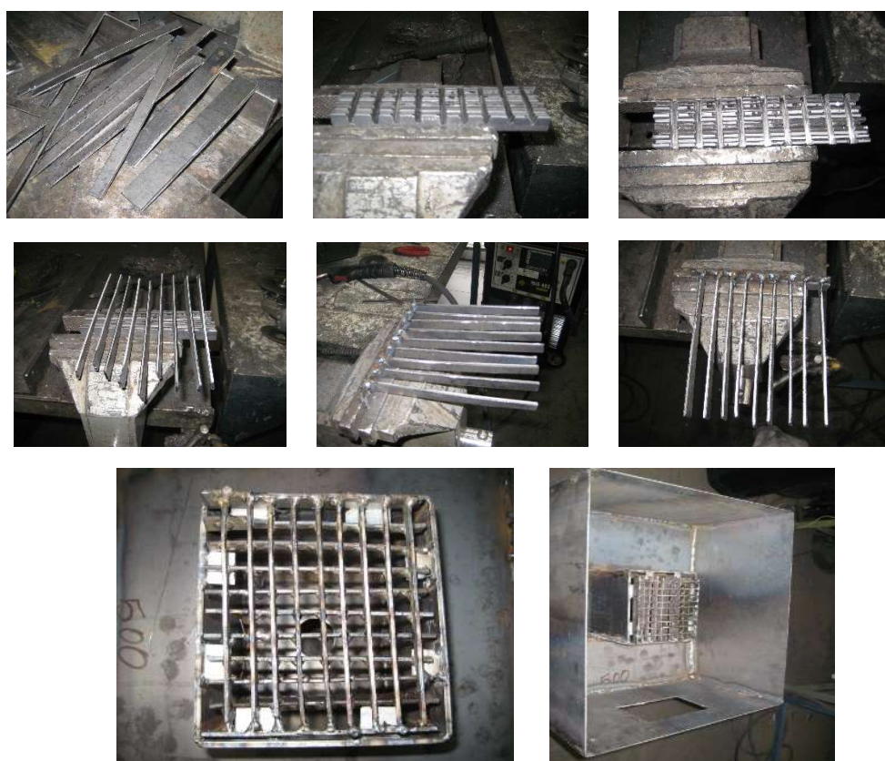
Figura 15 – Construção da grelha
