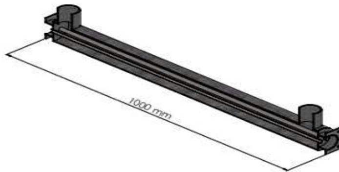
Figura 39 – Permutador em corte (LEMOS, 2019)
