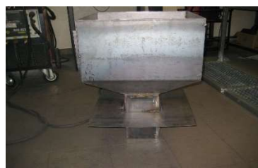
Figura 20 – construção da divisória do syngas
