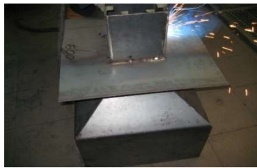
Figura 20 – construção da divisória do syngas
