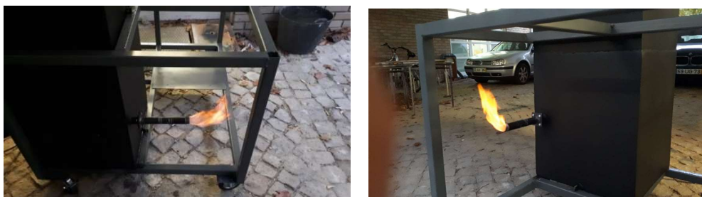
Figura 44 – Teste da produção de syngas
