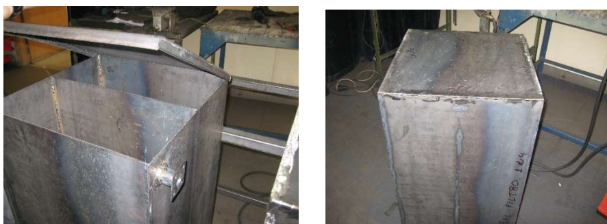
Figura 28 – colocação da tampa e fundo do filtro
