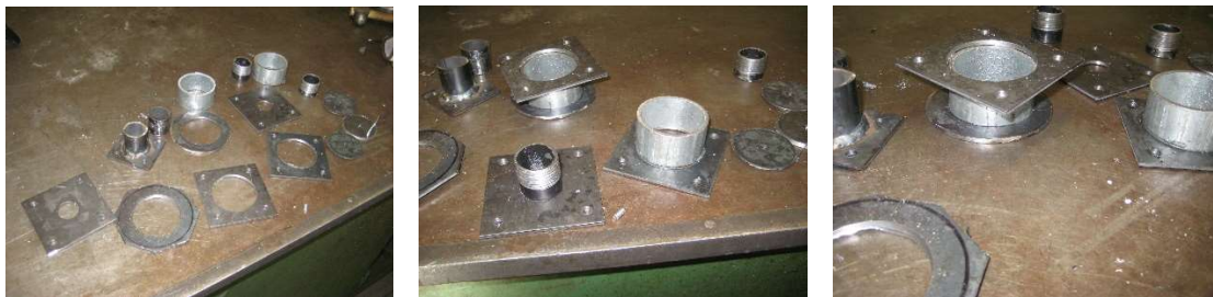
Figura 40 – Flanges e antecâmara do permutador
