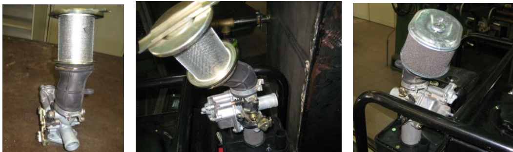
Figura 43 – Adaptação de um carburador Gás/Ar ao filtro do ar da motobomba
