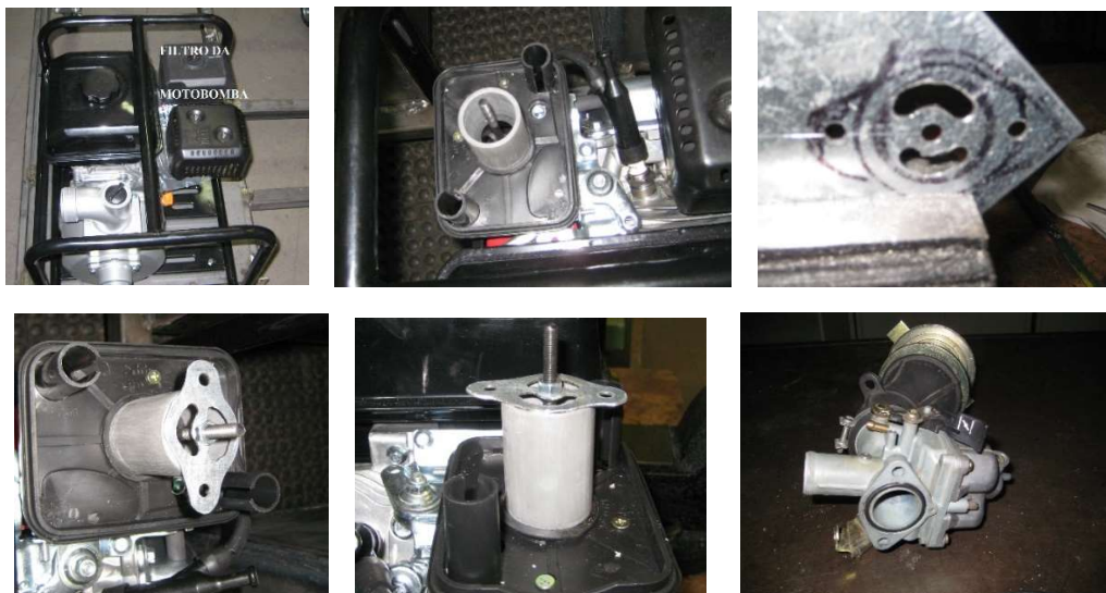
Figura 42 – Adaptar o carburador ao filtro da motobomba
