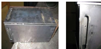
Figura 8 - Entrada de ar na lareira
