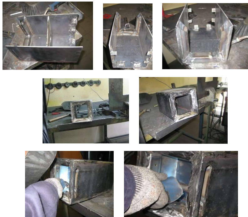
Figura 13 - Montagem das paredes da lareira
