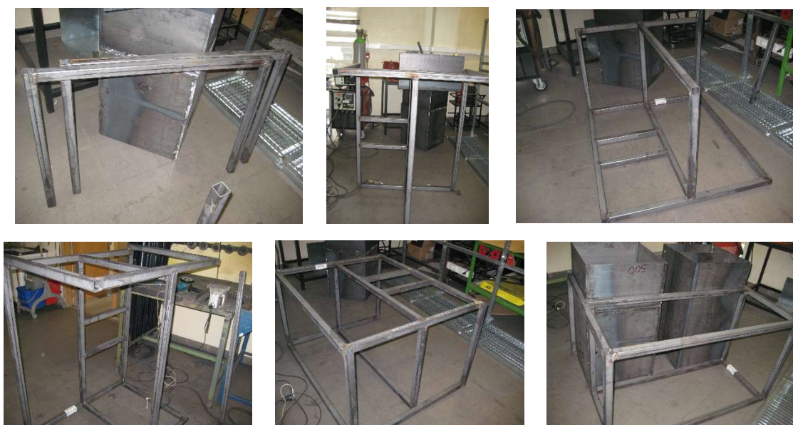
Figura 30 – Construção do carrinho de suporte
