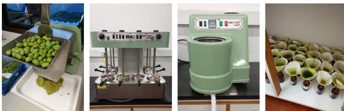
Figura 7 – Processo de extração dos azeites em sistema piloto Abencor.
