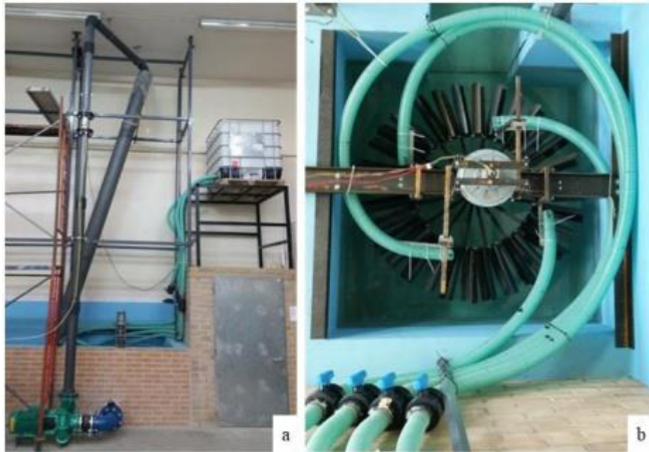
Figura 38 – a) Reservatório e tanque com roda d'água; b) Vista vertical da roda d'água [47].
