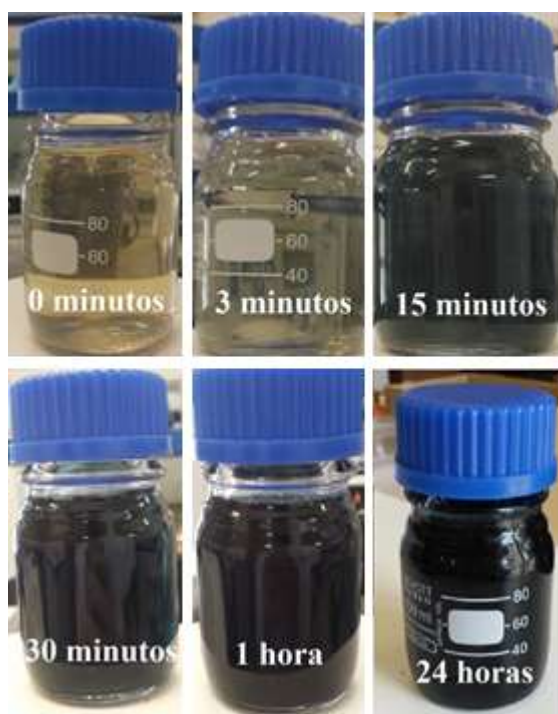
Figura 29- Variação da cor da solução ao longo do tempo na polimerização de EDOT:PSS.
