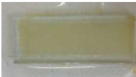
Figura 66- Fotoeletrodo com o dióxido de titânio antes da sinterização.
