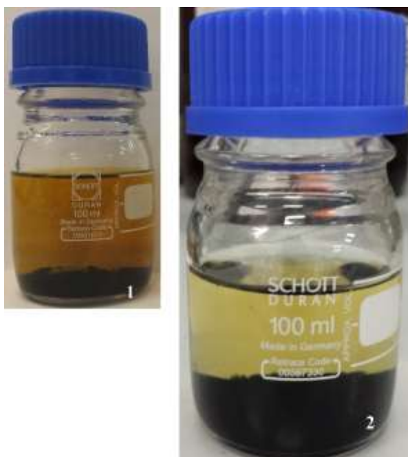
Figura 26- (1) Primeira lavagem do PEDOT. (2) Terceira lavagem de PEDOT.
