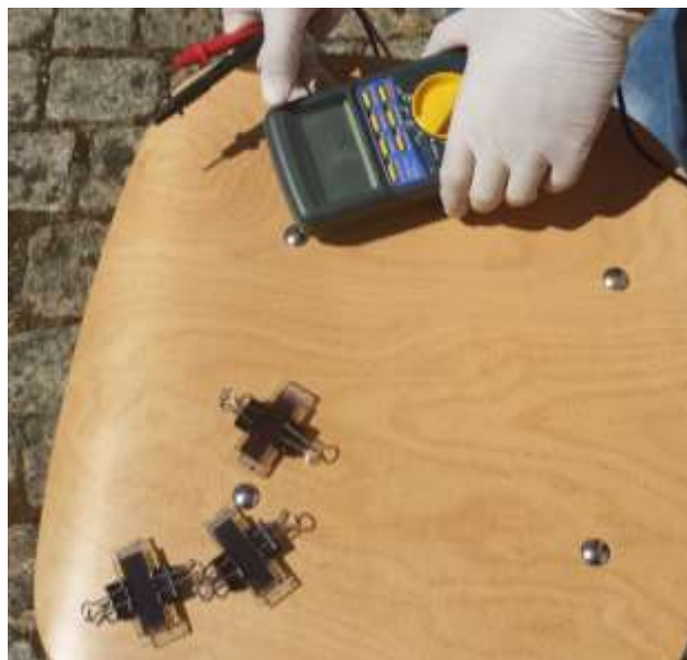
Figura 87- Método utilizado nas medições das DSC's artesanais.
