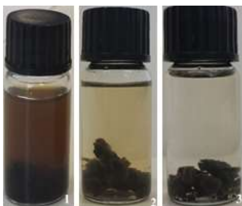
Figura 38- (1) Hidrogel com PEDOT:PSS antes da lavagem. (2) Hidrogel com PEDOT:PSS durante a lavagem. (3) Hidrogel com PEDOT:PSS depois da lavagem.
