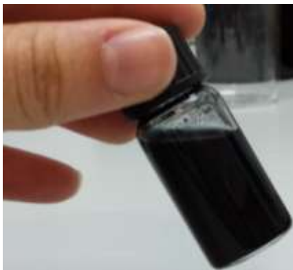
Figura 40- Aspeto final do produto obtido na interpenetração de PEDOT:PSS seco num hidrogel de ácido acrílico seco.
