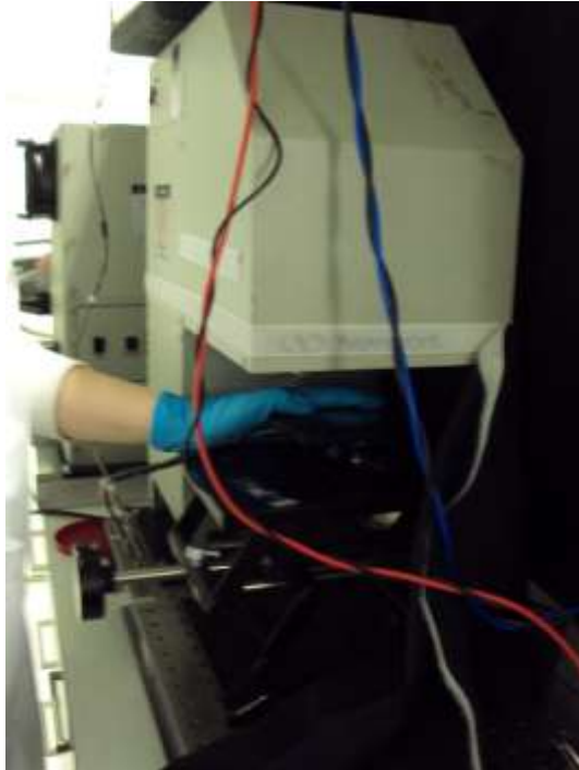
Figura 88- Aplicação da célula no simulador solar para a leitura da radiação I_s .
