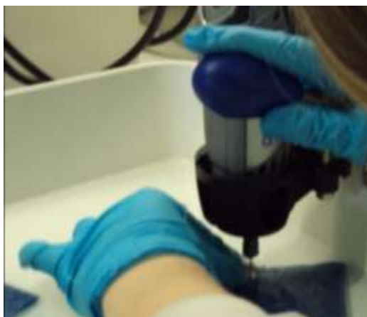
Figura 70- Procedimento de perfuração do vidro FTO, começa-se por furar até metade da espessura do vidro e o restante furo é efetuado do lado oposto do vidro para evitar que este se parta. São feitos dois furos em cada contra eletrodo.
