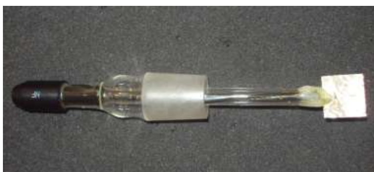
Figura 17- Eléctrodo de platina (área da superfície de trabalho: 4 cm 2 ).
