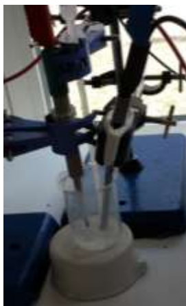
Figura 32- Configuração da célula eletroquímica utilizada na eletropolimerização do EDOT.
