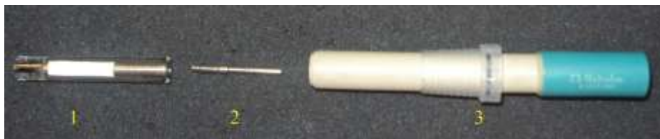
Figura 16- Eléctrodo de carbono vítreo. (1) Ponta de eléctrodo de carbono vítreo (M3, 2 mm). (2) Pin de contacto M3. (3) Suporte para ponta de eléctrodo.
