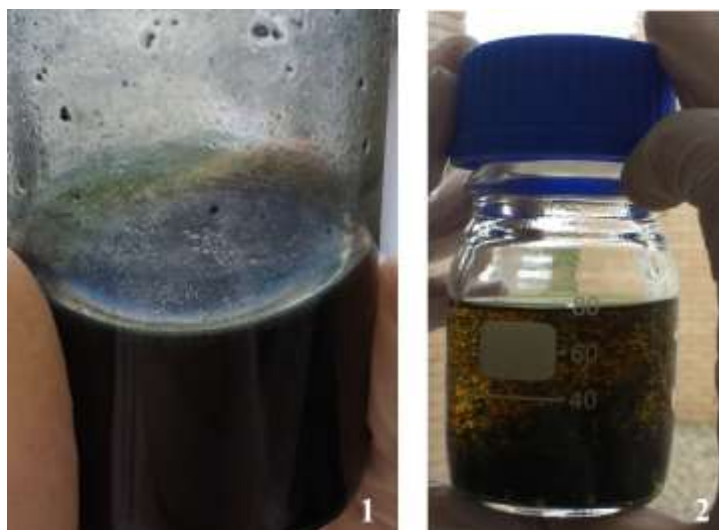
Figura 25- (1) Monómero que não reagiu. (2) Solução de metanol com PEDOT.
