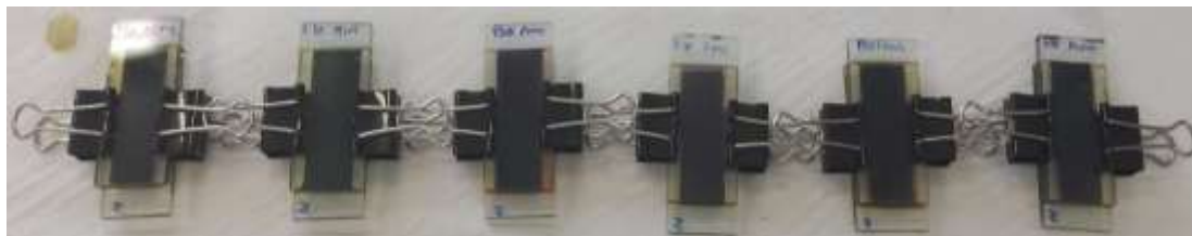
Figura 69- DSC's produzidas artesanalmente.
