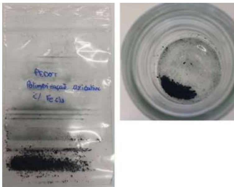
Figura 27- PEDOT obtido através de polimerização oxidativa com \text{FeCl}_3 .
