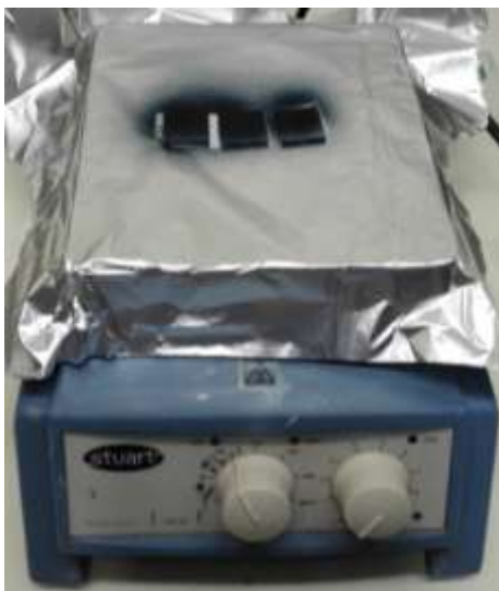
Figura 81- Prato de aquecimento utilizado, com os contra elétrodos cobertos pela solução de PEDOT:PSS.
