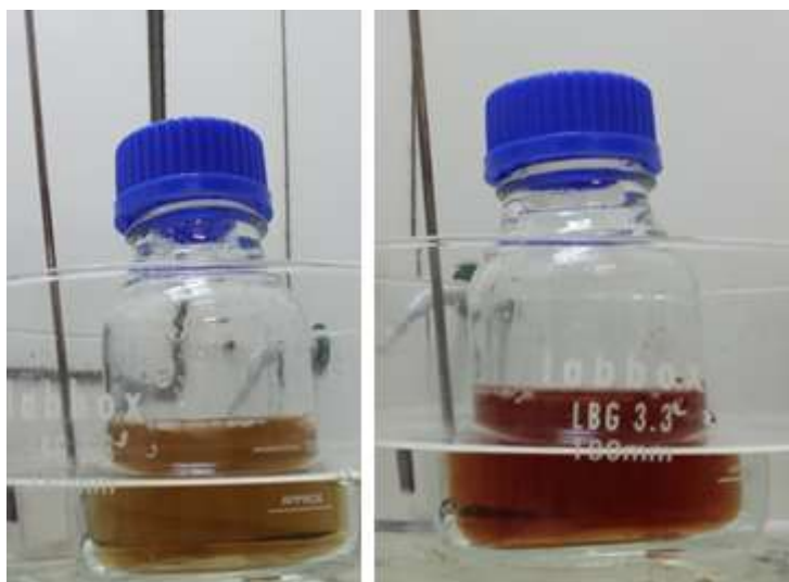
Figura 39- Evolução da cor ao longo da reação de síntese de PEDOT:PSS em simultâneo com a polimerização de hidrogel de ácido acrílico.
