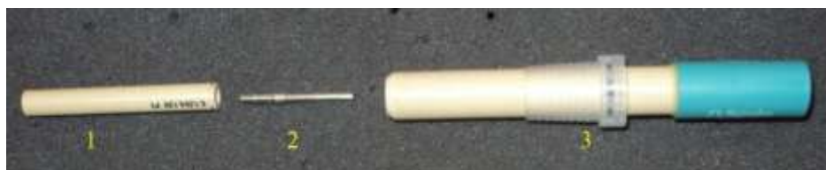
Figura 15 – Elétrodo de platina. (1) Ponta de elétrodo de platina (M3, 2 mm). (2) Pin de contacto M3. (3) Suporte para ponta de elétrodo.
