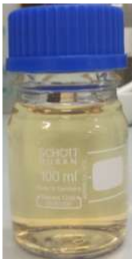
Figura 28- Mistura de H 2 O DI, PSS e EDOT.
