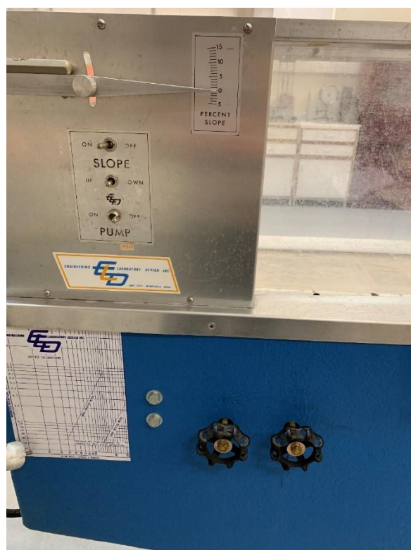
Figura 51 - Mecanismo de torneiras de aumento do caudal e interruptores de variação do ângulo, presentes no canal hidráulico
