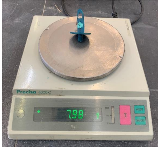
Figura 55 - Fotografia da medição da massa necessária para o equilíbrio do ensaio nº2
