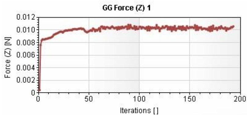
Figura 71 - Gráfico dado pelo Flow Simulation da resultante da força de arrasto para o ensaio nº1
