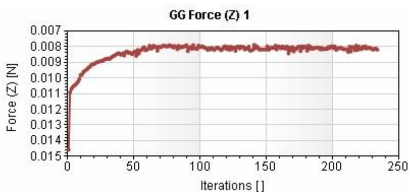
Figura 77 - Gráfico dado pelo Flow Simulation da resultante da força de arrasto para o ensaio nº4
