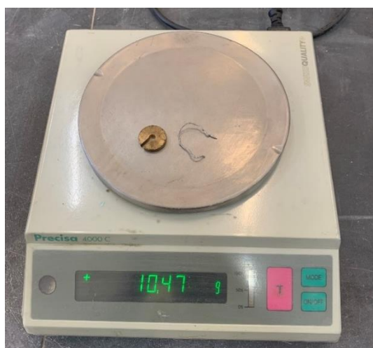
Figura 57 - Fotografia da medição da massa necessária para o equilíbrio do ensaio nº3
