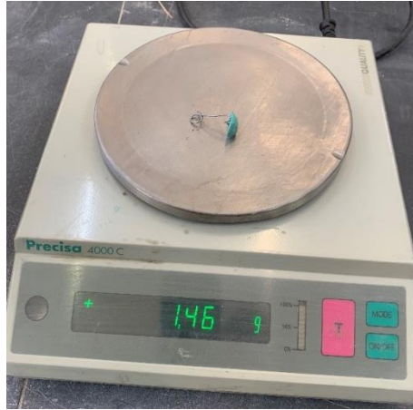
Figura 53 - Fotografia da medição da massa necessária para o equilíbrio do ensaio nº1
