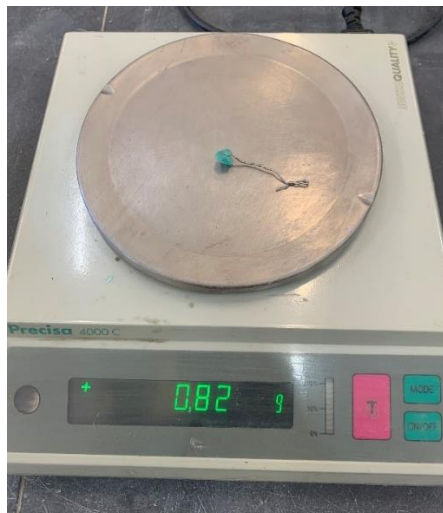
Figura 59 - Fotografia da medição da massa necessária para o equilíbrio do ensaio nº4
