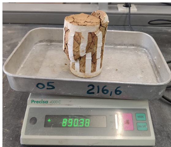
Figura 2.8: Rotura de amostra após ensaio triaxial
