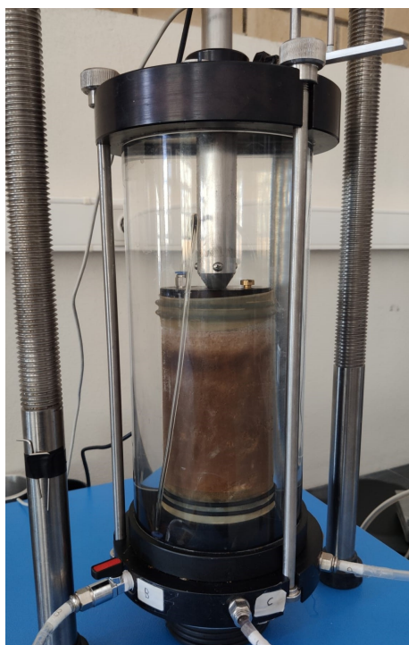
Figura 4.4: a) Câmara triaxial instalada na máquina eletromecânica de teste.
