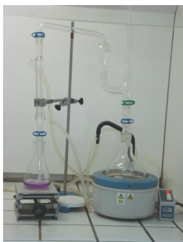
Figura 18 – Montagem experimental para determinação do N_{org} de Kjeldahl.
