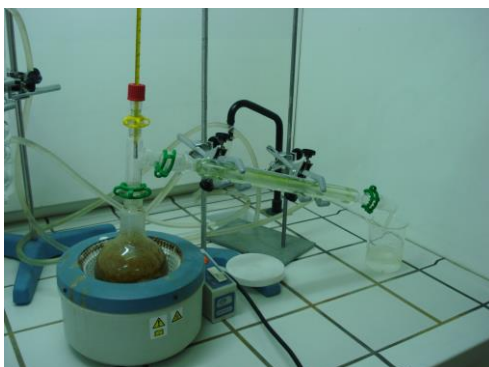
Figura 19 – Montagem para determinação dos óleos e gorduras.
