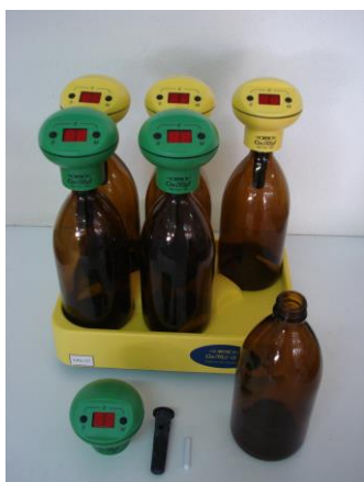
Figura 16 – Conjunto OxiTop® para determinação da CBO de uma água residual.
