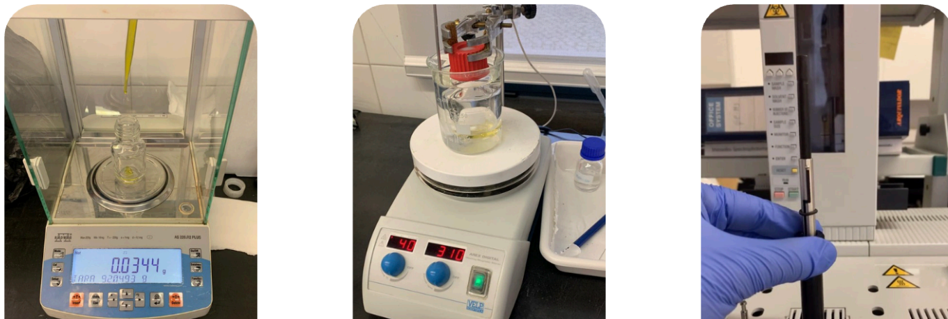
Figura 5 - Preparação das amostras para análise do perfil volátil por cromatografia gasosa acoplada por espectrometria de massa.
