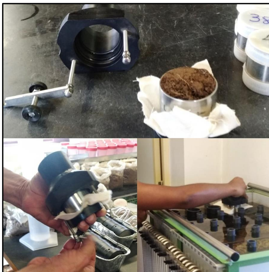
Figura 11: Etapas para introdução das amostras no permeâmetro.
