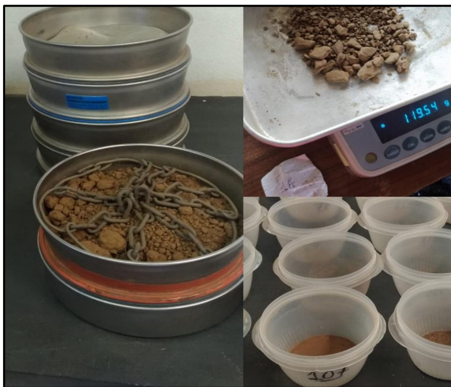
Figura 13: Processo de separação das partículas de elementos grosseiros e terra fina.
