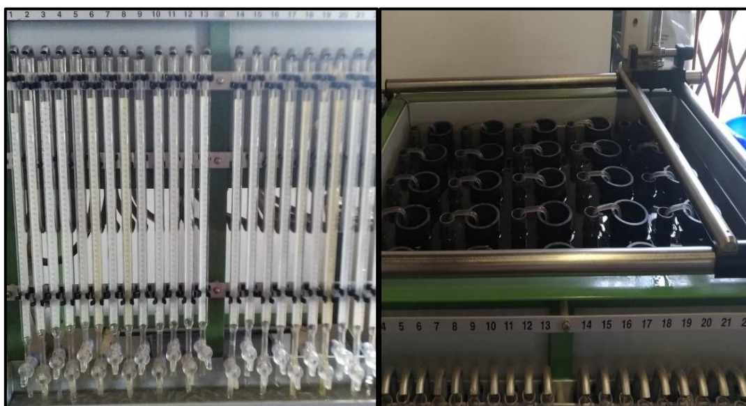
Figura 10: Vista frontal e superior do permeâmetro.
