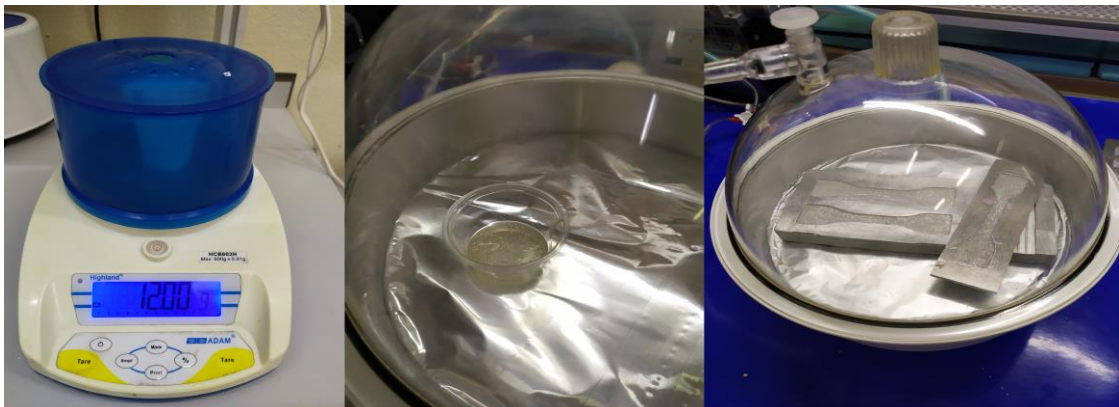
Figura 11: Balança utilizada, retiradas de bolhas em PDMS com cera de abelha, retirada bolhas no molde.
