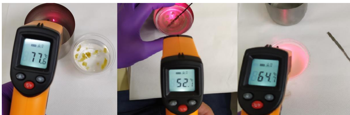
Figura 12: Procedimento de mistura para PDMS com 1% de cera de abelha.
