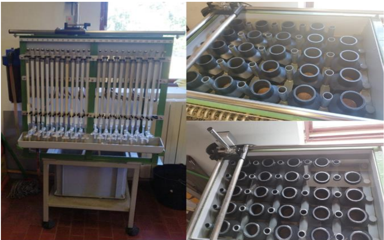
Figura 10. Permeâmetro de circuito fechado utilizado na avaliação da permeabilidade do solo. Fonte: Keller (2024).
