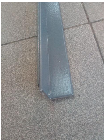
Figura 44. Cantoneiras em L antes de cravadas.
