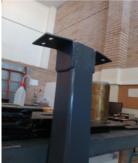
Figura 42 Peças em L de fixação da estrutura do topo.
