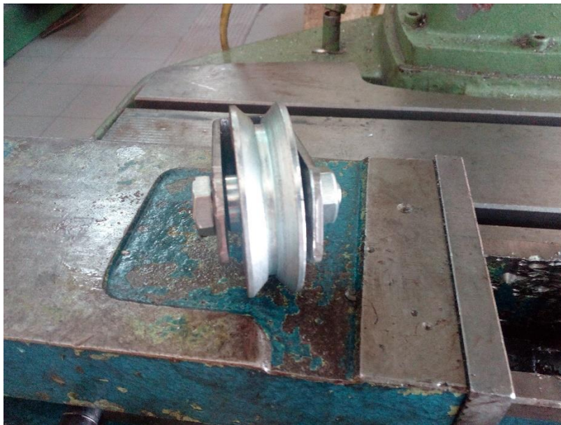
Figura 47. Rolamento inserido na sua união de fixação.
