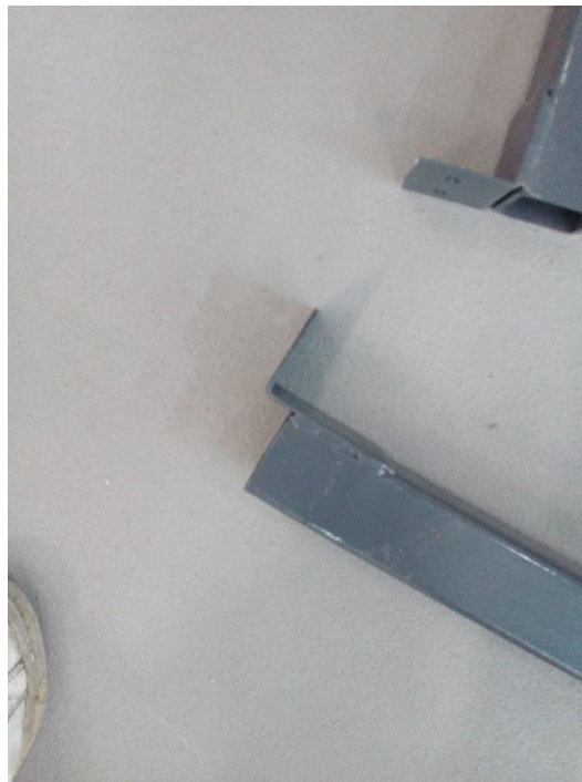
Figura 40. Peças de união laterais com as ligações em L soldadas.
