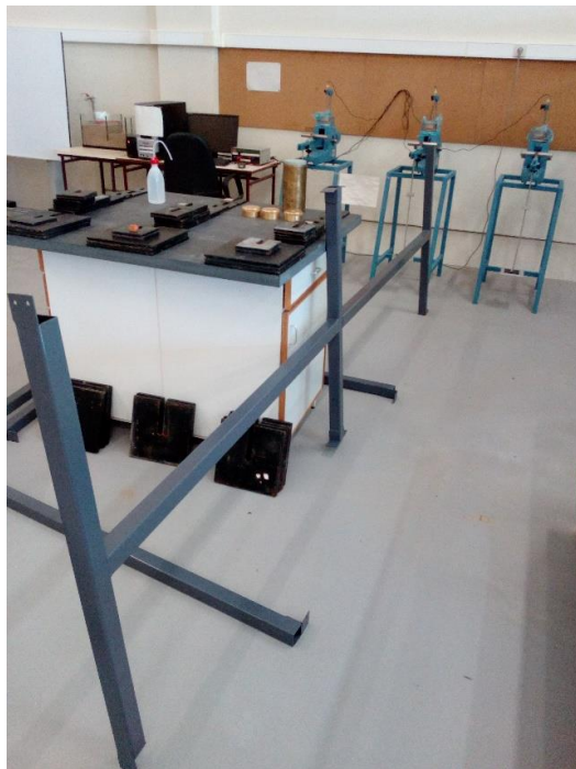
Figura 43. Estrutura superior de ajuste criada por múltiplas peças soldadas.
