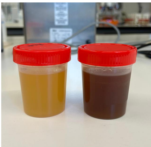
Figura 24: Revestimentos comestíveis obtidos a partir de R. Officinalis L. (esquerda) e G. robertianum L. (direita)
