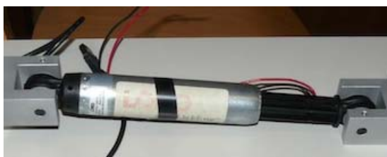
Figura 5: Amortecedor MR – RD-1097-01 (Lord Corp.)
