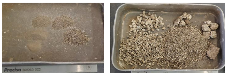
Figura 13 - Resultado da peneiração dos materiais finos e grossos
