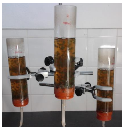
Figura 4.17 - Otimização do processo - aspeto dos fotobiorreatores do tipo coluna de bolhas, 2 fases a 50%.
