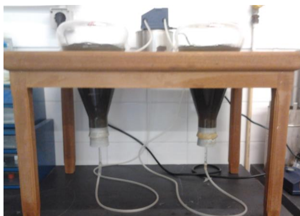
Figura 4.16 - Otimização do processo - aspeto das culturas com efluente sem conservação a 50%, 2 fases.
