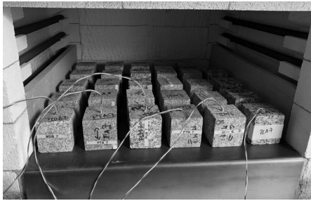
Figura 1: Provetes no forno de aquecimento
