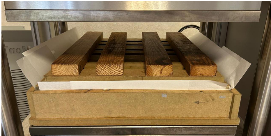
Figura 16: Molde inserido no interior da prensa termohidráulica.
