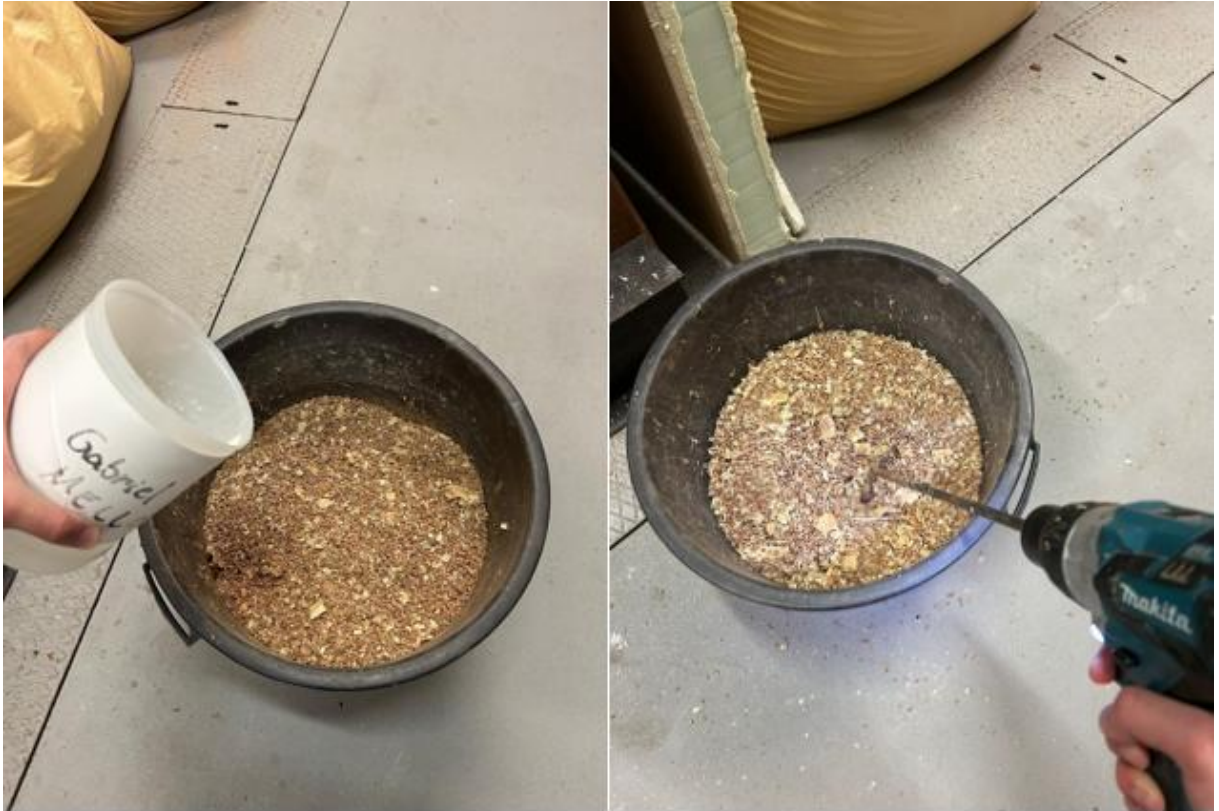
Figura 12: Passo 4 – Despejar a resina e misturar todos os componentes.
