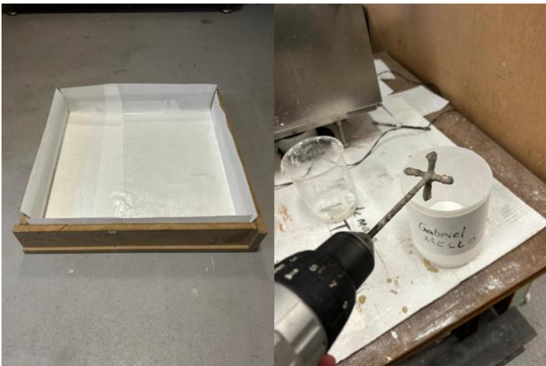
Figura 11: Passos 2 e 3 – Preparar o molde com as folhas e misturar a resina com a água respectivamente.
