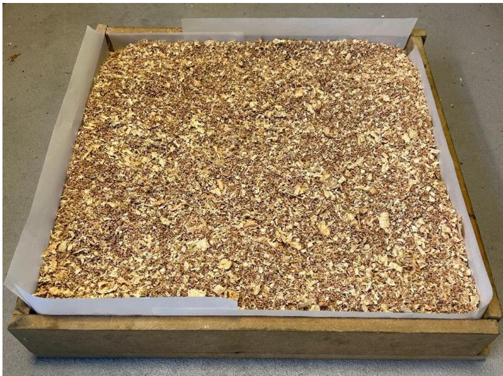
Figura 13: Passo 5 – Colocar e ajeitar a mistura no molde.
