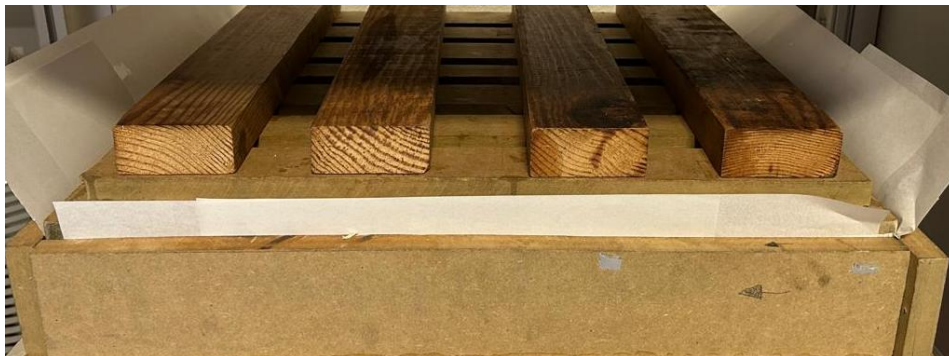
Figura 15: Passo 7 - Tampar o molde.
