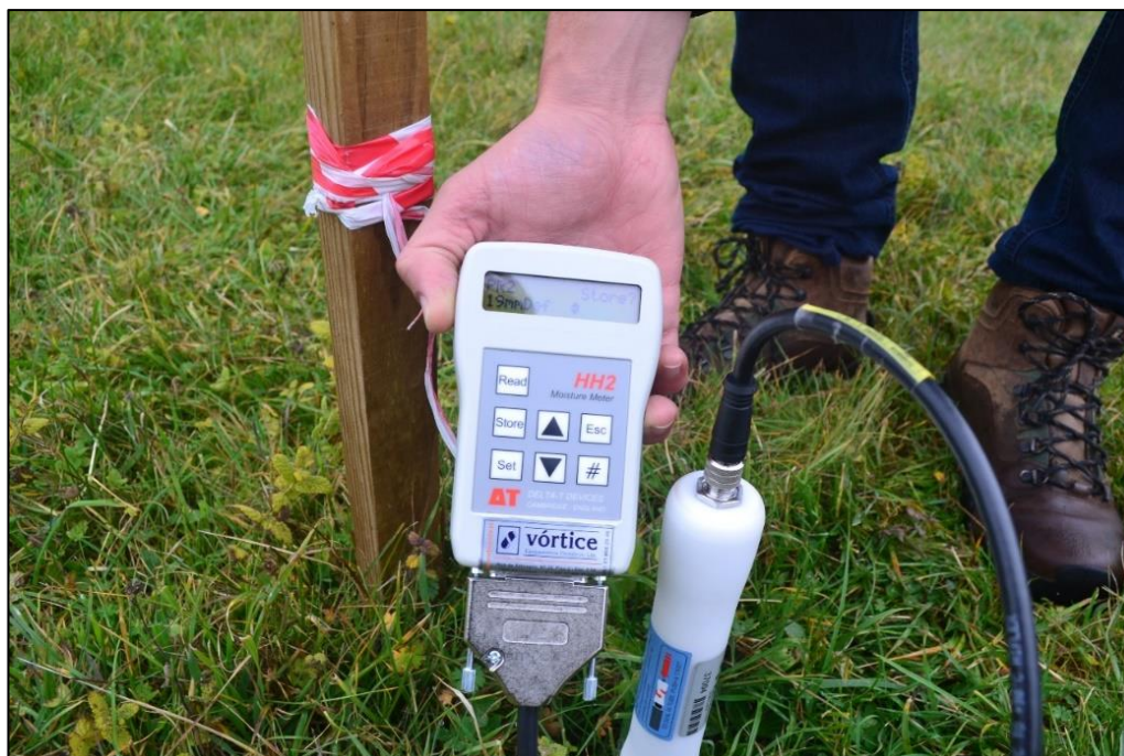
Figura 7: tomada de dados através da Sonda PR2 Moisture acoplada com leitor HH2 . Fonte: autor, 2022.
