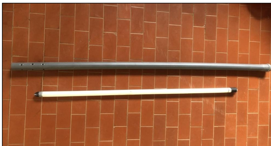
Figura 9: tubo piezométrico e tubo de acesso da sonda PR2 Moisture .
