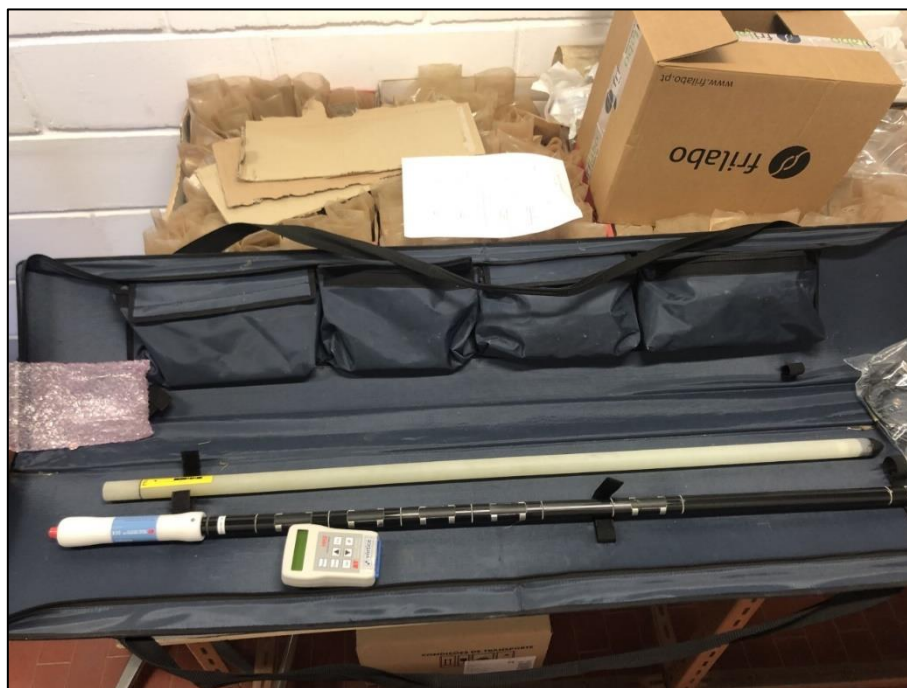
Figura 6: Sonda PR2 Moisture, leitor HH2, tubo e capa protetora. Fonte: autor, 2022.
