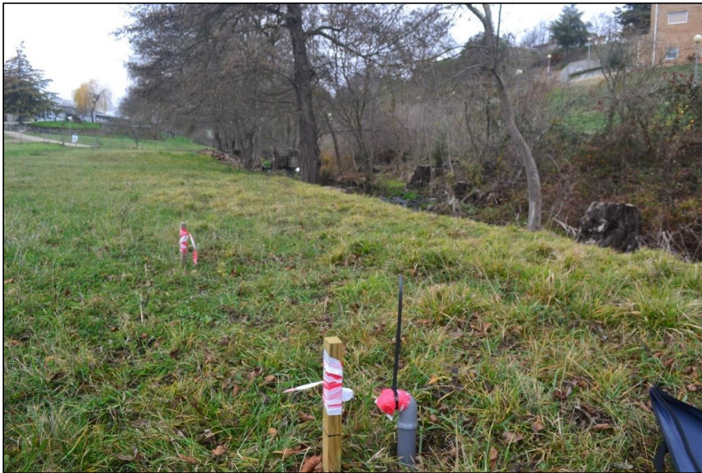
Figura 10: Lameiro do Campus do IPB e tubos de acesso (sonda PR2 e piezômetro) instalados e sinalizados.
