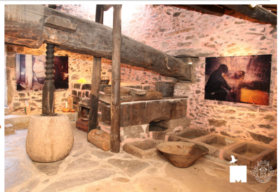
Interior do antigo lagar comunitário de prensa de vara de Felgueiras (Torre de Moncorvo). Fotografias cedidas pela Câmara Municipal de Torre de Moncorvo.
