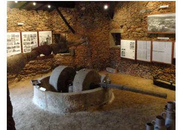
Olival, Azibo (Macedo de Cavaleiros). Talha de azeite e pio em pedra com duas galgas, Núcleo Museológico do Azeite, aldeia dos Cortiços (Macedo de Cavaleiros). Fotografias de Alexandra Vieira.
