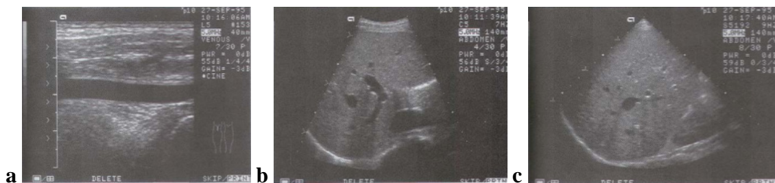
Figura 7 – Imagens obtidas por diferentes tipos de transdutores: a) Transdutor Linear; b) Transdutor Convexo; c) Transdutor Setorial [15].
