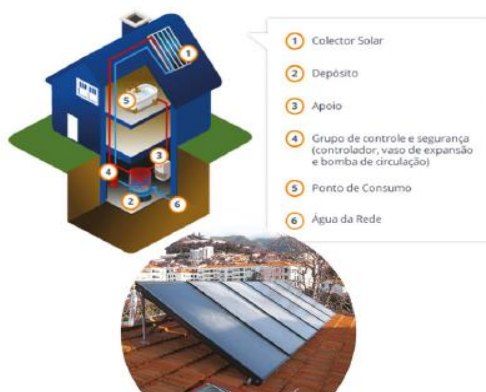
Figura 29- Sistema de circulação fechada (Fonte: ADENE)
