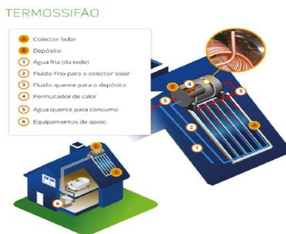
Figura 28- Sistema de termossifão (Fonte: ADENE)
