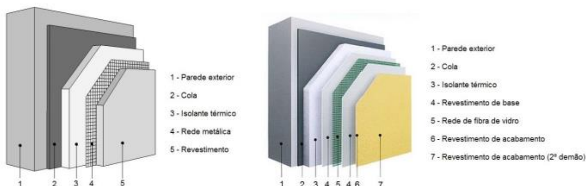
Figura 16- Sistema de isolamento térmico com revestimento espesso (esquerda). Sistema de isolamento térmico com revestimento delgado (direita). (Fonte: PLASTIMAR)
